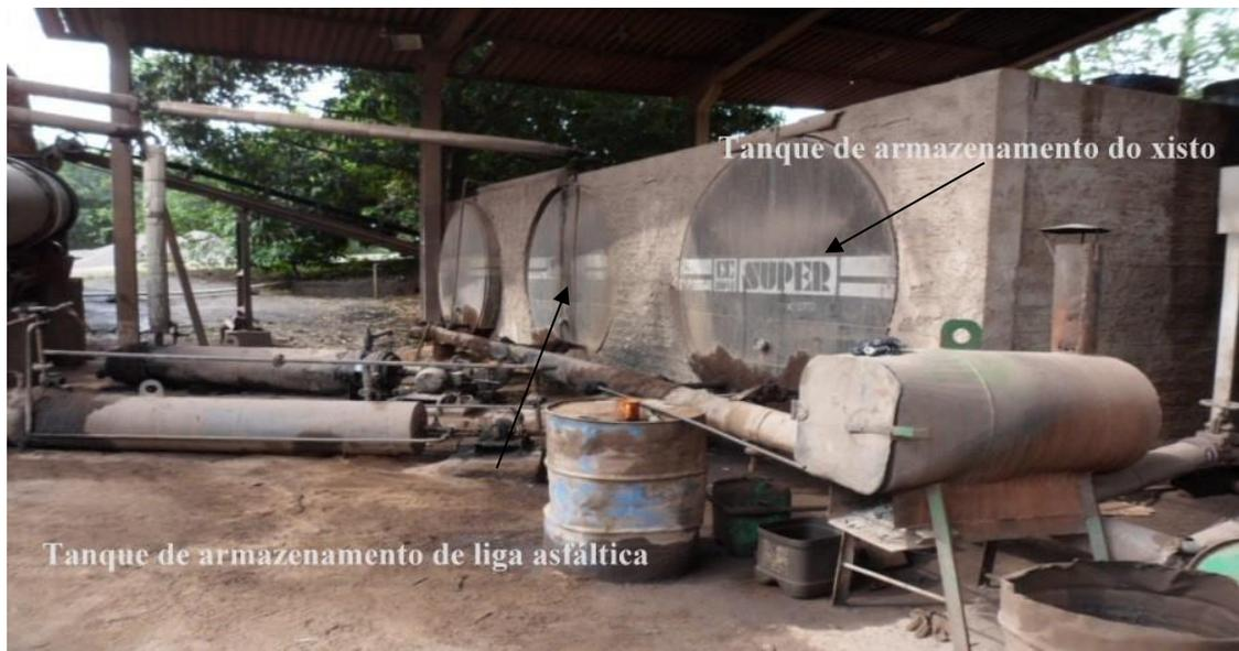
Figura 4: Tanques de armazenamento de xisto e de liga asfáltica.
