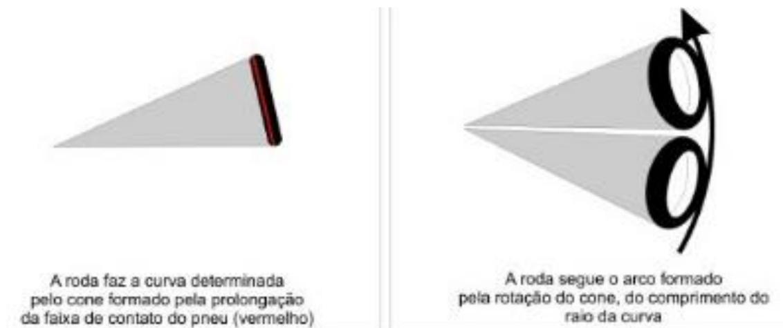
Figura 7: Prolongamento da faixa de contato do pneu forma um cone com o raio da curva.
