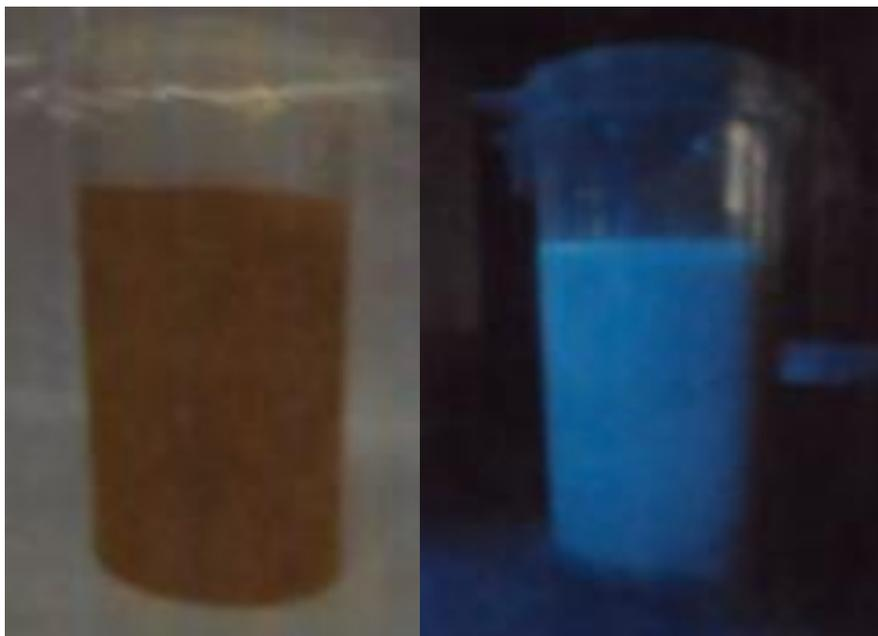
Figura 10: Presença dos coliformes totais sem UV e presença dos coliformes totais com UV.
