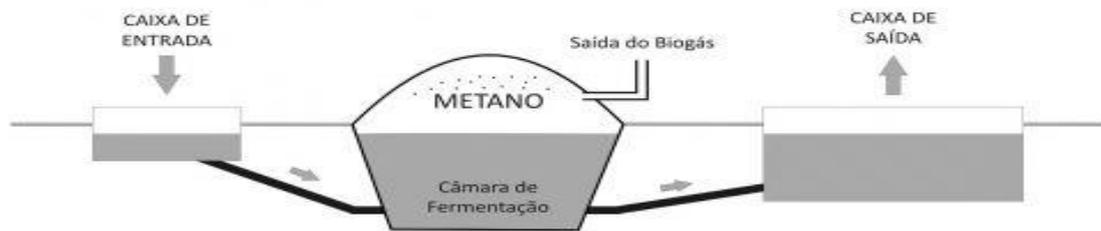
Figura 1: Esquema do processo de biodigestor.
