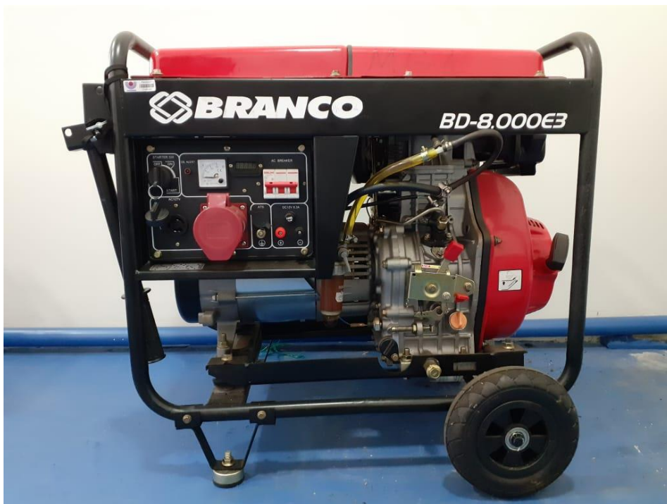
Figura 15. Conjunto motor gerador.
