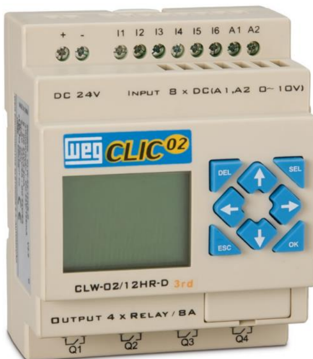
Figura 8. Módulo de controlador lógico programável – CLP Fonte: (WEG, 2010)
