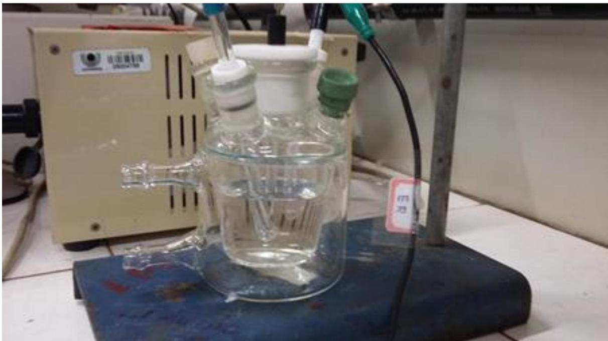
Figura 5 - Potenciostato de microquímica e célula eletroquímica utilizados em escala laboratorial.
