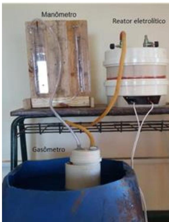
Figura 7 - Sistema completo desenvolvido para a produção de hidrogênio.
