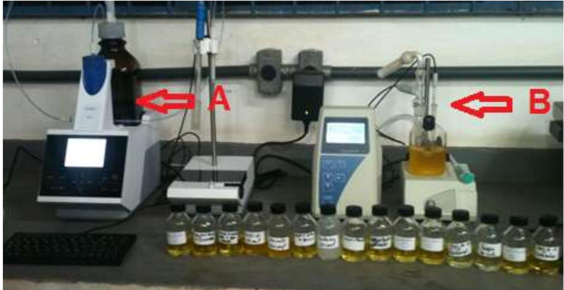
**Figura 13** - Equipamentos para análises de acidez (A) e umidade (B).
