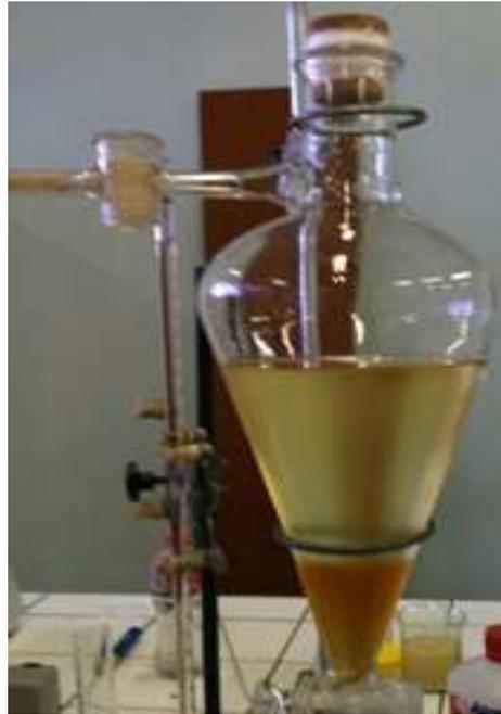
**Figura 16** - Processo de decantação do biodiesel de soja.
