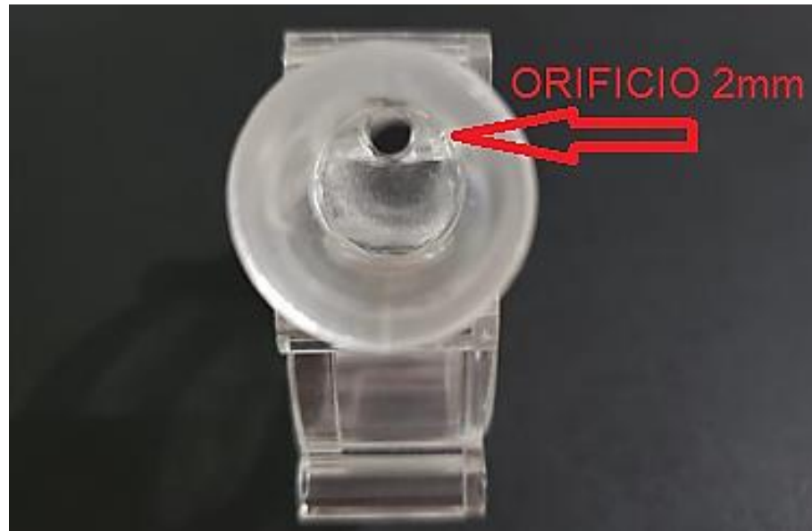
Figura 8 - Microturbina hidrelétrica com seção interna de 2mm.
