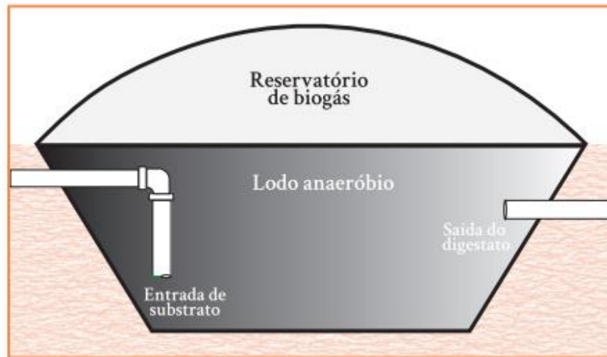
Figura 1. Esquema representativo reator modelo Canadense.
