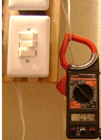
Figura 13 - Alicates amperímetro, marca Instrutherm, modelo VA-750.
