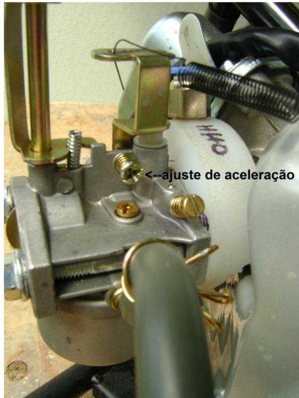
Figura 15 - ajuste manual de aceleração e rotação.
