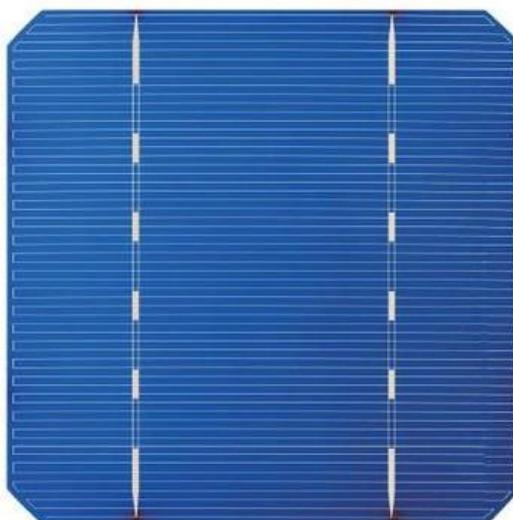
Figura 9 – Célula de silício monocristalino.
