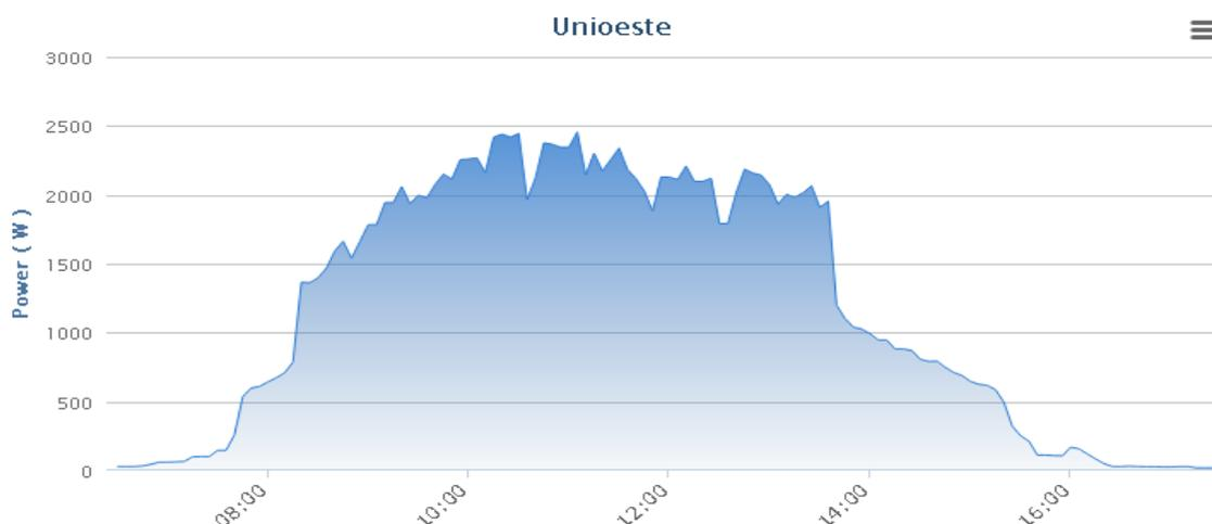
Figura 27 – Curva de carga diária do sistema fotovoltaico.
