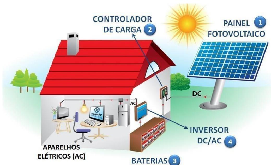
Figura 8 – Sistema fotovoltaico isolado (SFVI) ou *Off Grid*.
