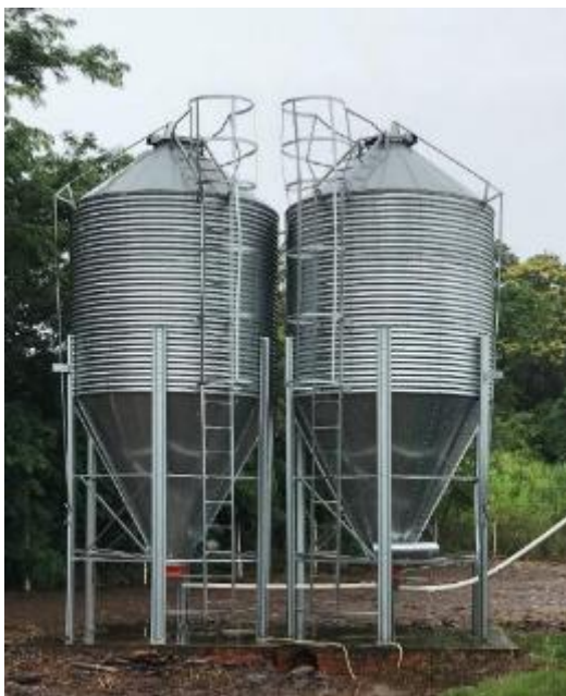
Figura 56: Sistema de nutrição – Silos Avioeste – Capacidade 16 toneladas.
