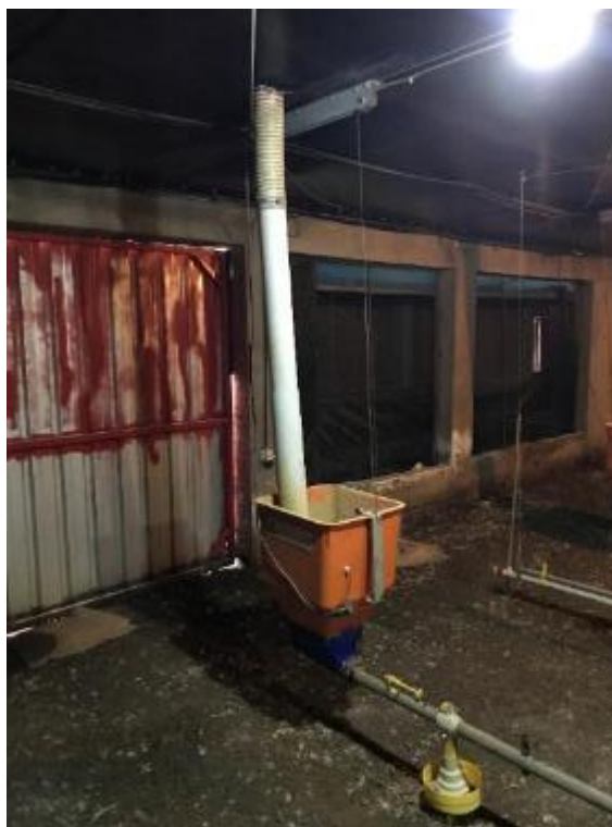
Figura 55: Sistema de nutrição - Comedouro. Linha primária de distribuição.
