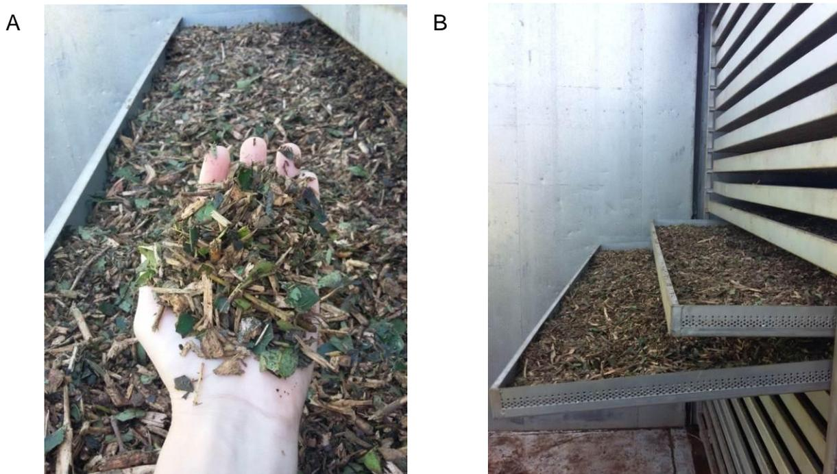
Figura 2. Resíduos de podas urbanas. A - Material triturado. B – Acondicionamento no secador
