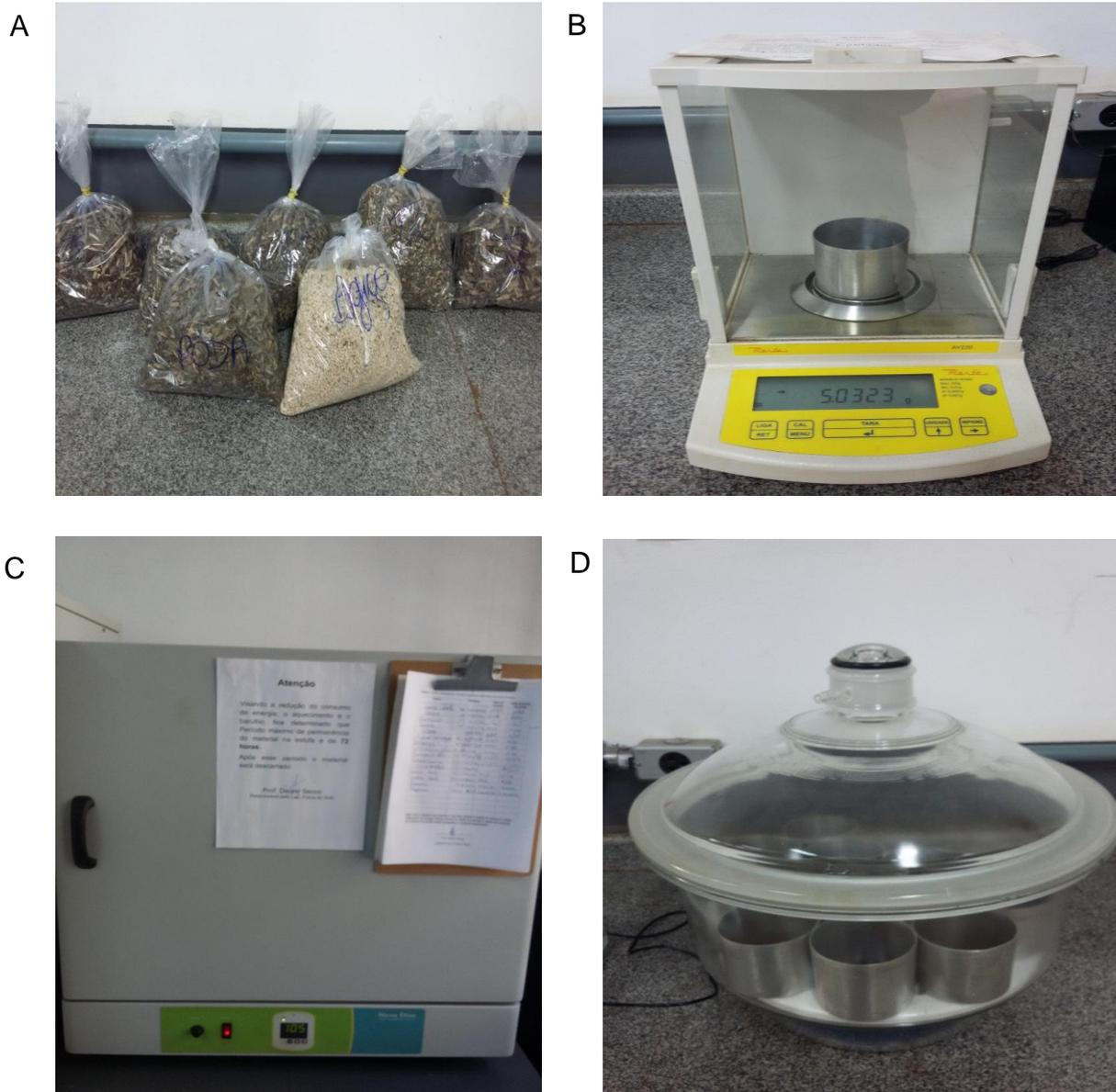
Figura 8: Equipamentos empregados nos ensaios de teor de umidade. A – Amostra antes da secagem. B – Balança digital. C – Estufa. D – Dessecador
