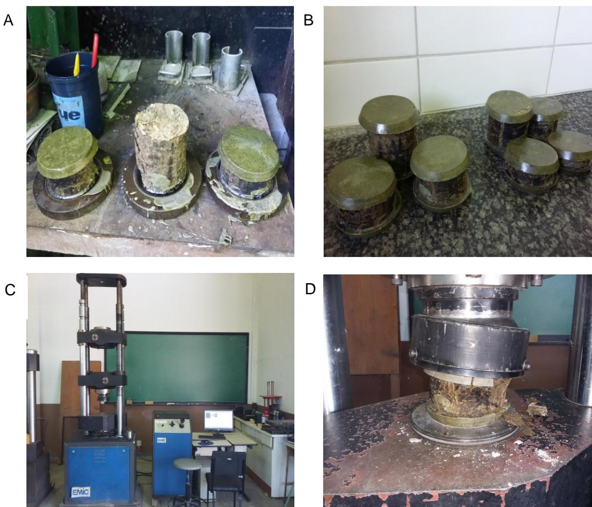
Figura 10: Equipamentos empregados na análise de resistência mecânica. A – Moldes para regularizar a superfície dos briquetes. B – Briquetes com a superfície de enxofre. C – Prensa hidráulica. D – Momento de ruptura do briquete
