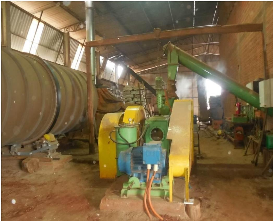
Figura 5: Briquetadeira mecânica de pistão
