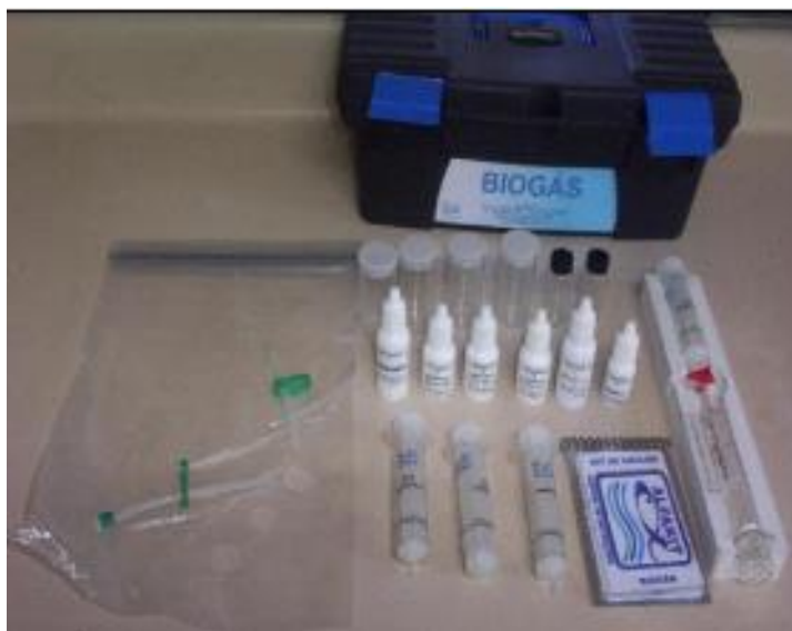
Figura 14. Kit de análise de biogás Alfakit – Embrapa utilizado no experimento.
