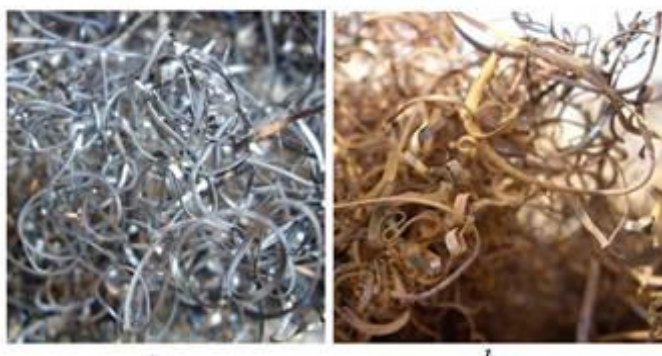
Figura 1. Limalha de ferro antes e depois da oxidação pelo gás sulfídrico. Fonte: Bui et al. (2008).
