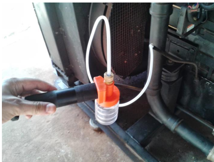
Figura 11. Bomba de coleta de lubrificante a vácuo, inserida na haste da vareta de lubrificante para a obtenção das amostras.
