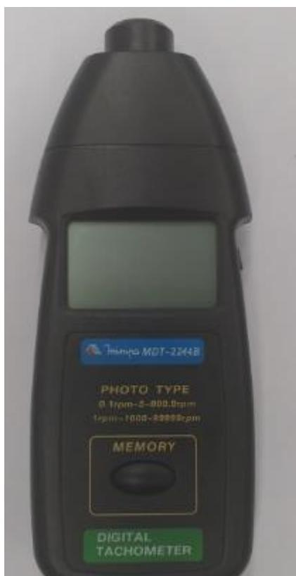
Figura 36 - Tacômetro Digital modelo MDT-2244B
