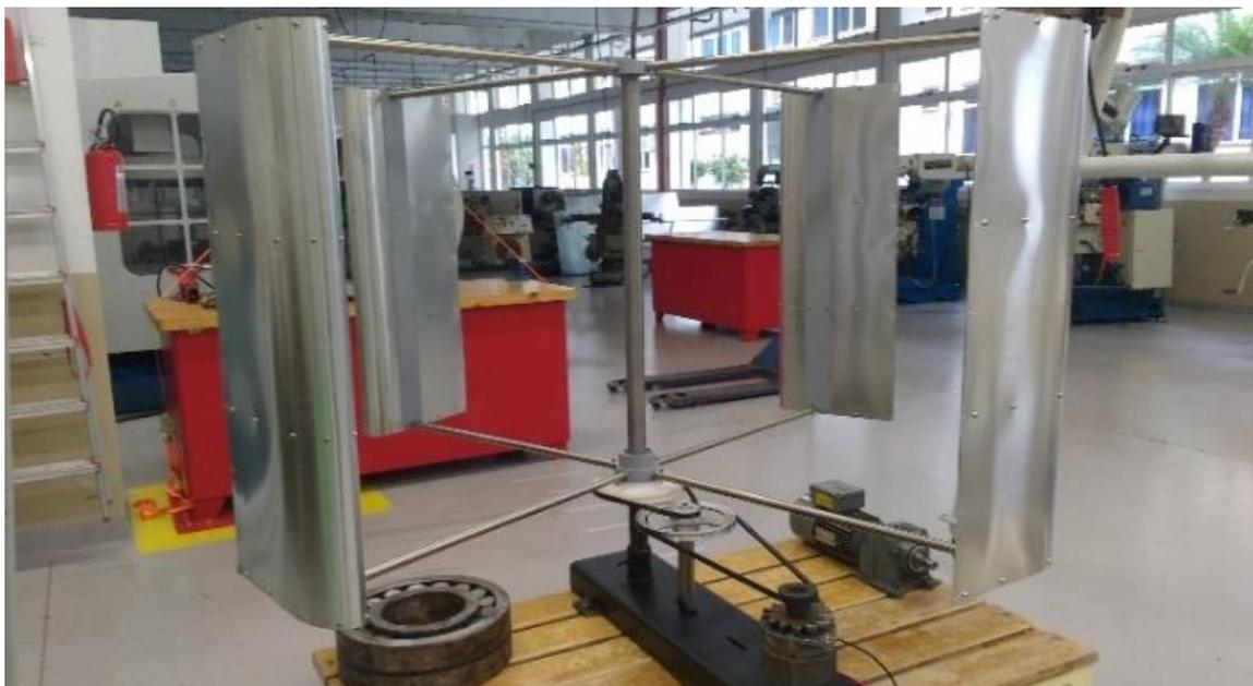
Figura 17 - Aerogerador de Eixo Vertical
