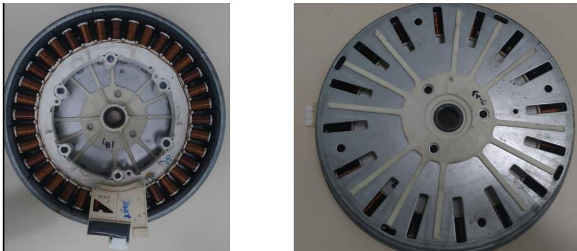
Figura 26 - Motor de Corrente Alternada com Imãs Permanentes
