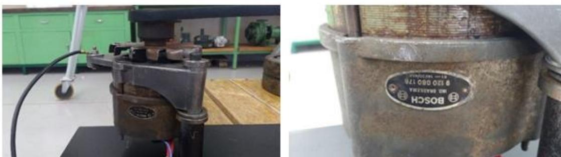
Figura 28 - Modelo gerador CA tipo alternador automotivo
