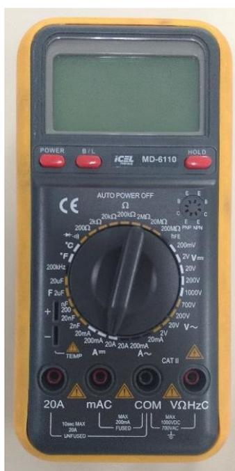
Figura 30 - Multímetro Digital modelo MD-6110
