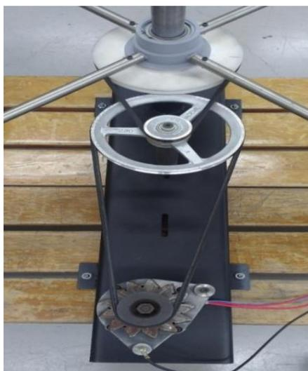
Figura 20 - Conjunto de ampliação de rotação alternador automotivo
