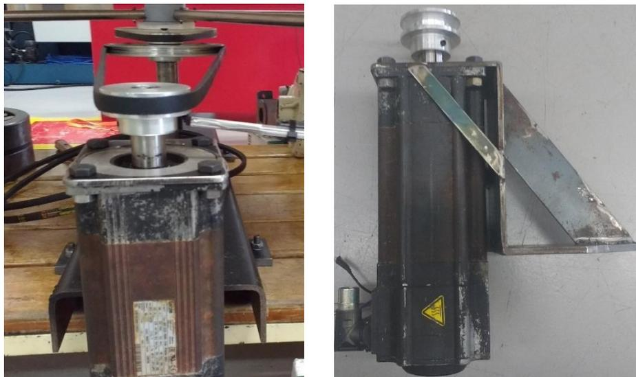
Figura 19 - Conjunto de ampliação de rotação servomotor
