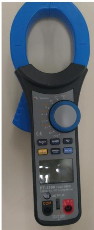
Figura 32 - Alicate Amperímetro Digital modelo ET-3990
