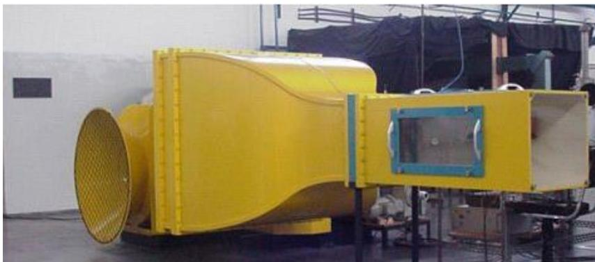
Figura 13 - Túnel de Vento
