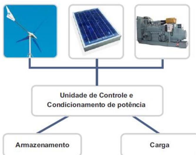
Figura 15 - Configuração de um sistema híbrido solar-eólico-diesel
