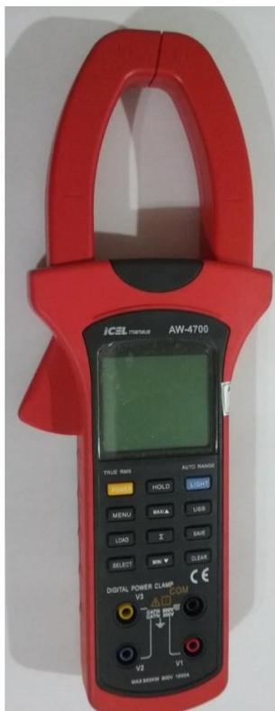
Figura 33 - Alicate Wattímetro Digital modelo AW- 4700
