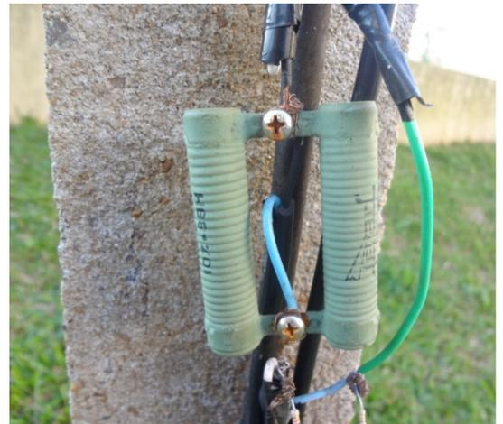
Figura 19 – Divisor de tensão; resistência shunt.
