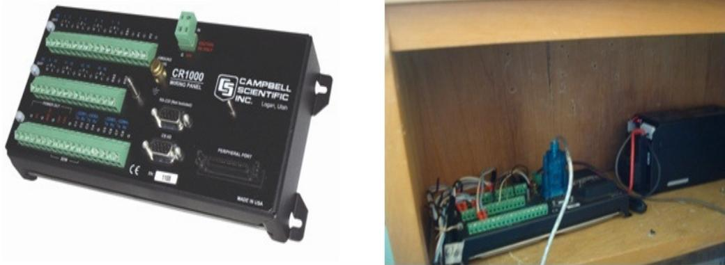
Figura 17 – Datalogger Campbell e conexões.
