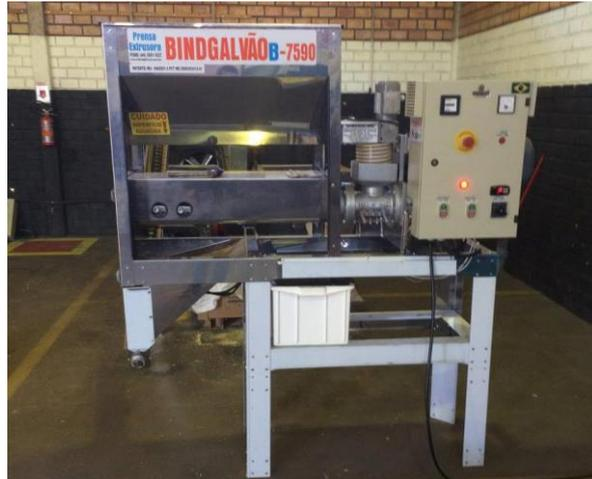
Figura 5: Prensa *Expeller* para extração de óleo de crambe.
