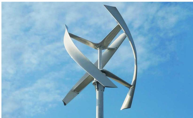
Figura 4: Aerogerador de eixo vertical.
