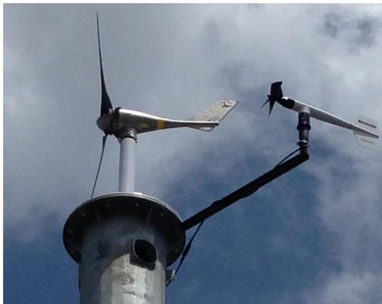
Figura 21: Anemômetro instalado.
