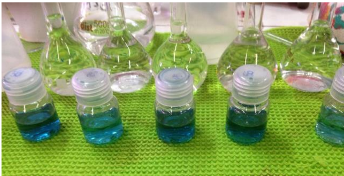
Figura 15: Amostras de Solução de Sulfeto de Sódio após a realização do teste Alfakit sem a adição de nanopartícula.
