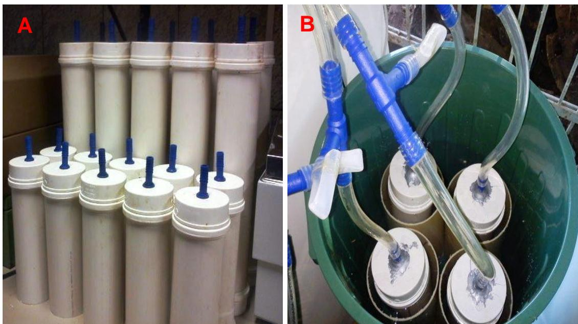
**Figura 16.** a) Reatores e gasômetros confeccionados; b) Gasômetros visualizados ao exterior das estufas.
