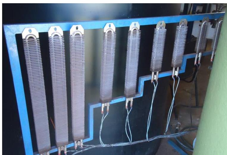
**Figura 17 - Banco de resistores elétricos.**
