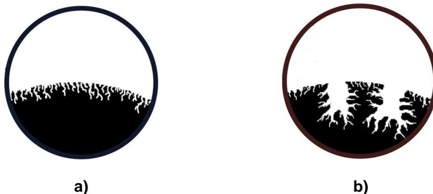
**Figura 2.** Estrutura a) microporosa e b) micro-mesoporosa de carvão ativado.
