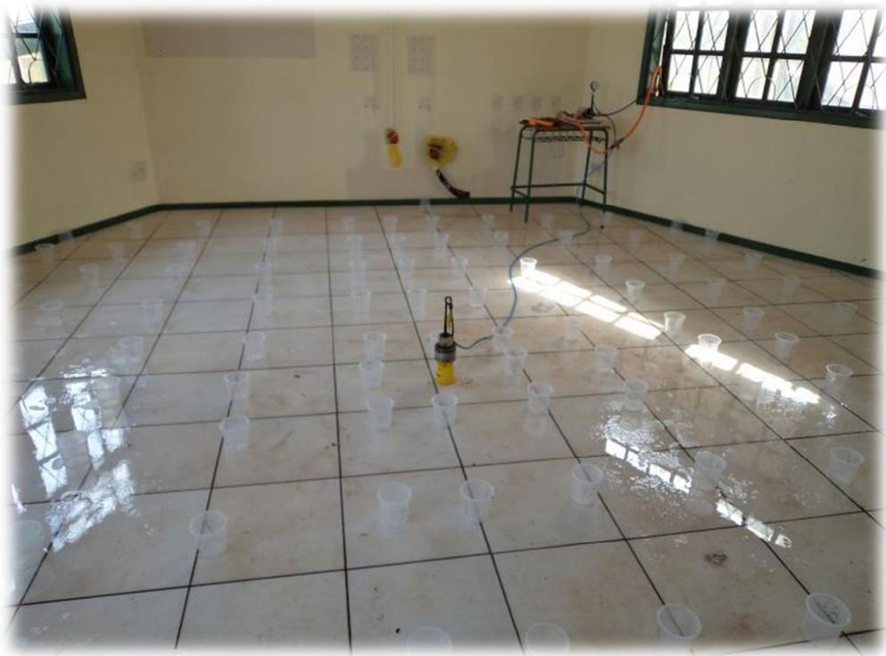
Figura 13. Ensaio do microaspersor.
