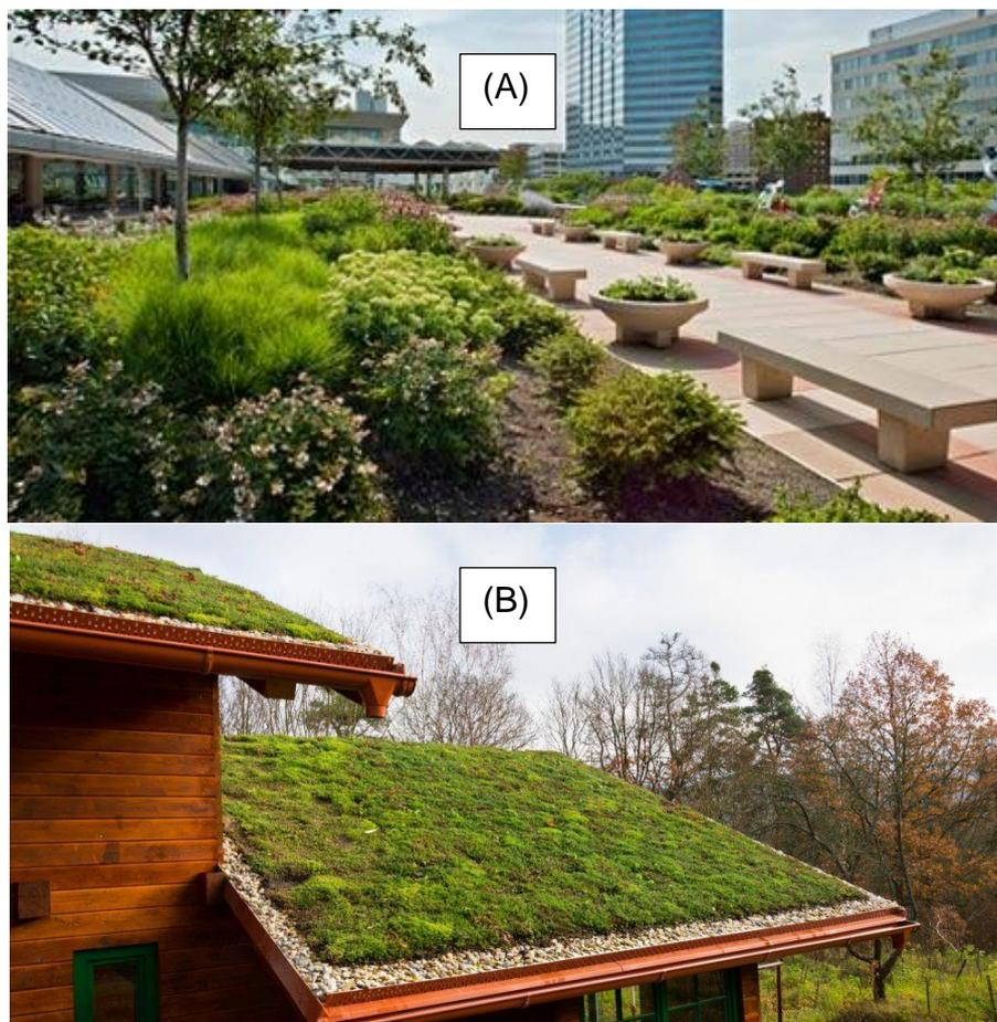
**Figura 4:** Exemplos de telhado verde intensivo (A) e extensivo (B).
