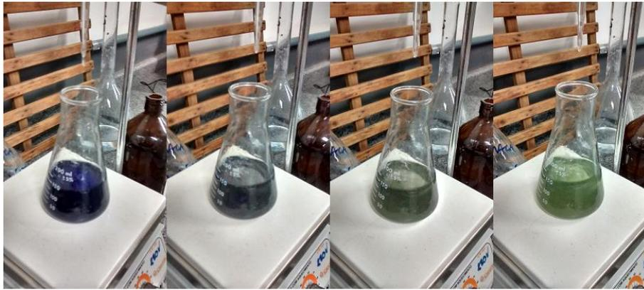
Figura 3. Mudança de cor durante a titulação das amostras com sulfato ferroso amoniacal.
