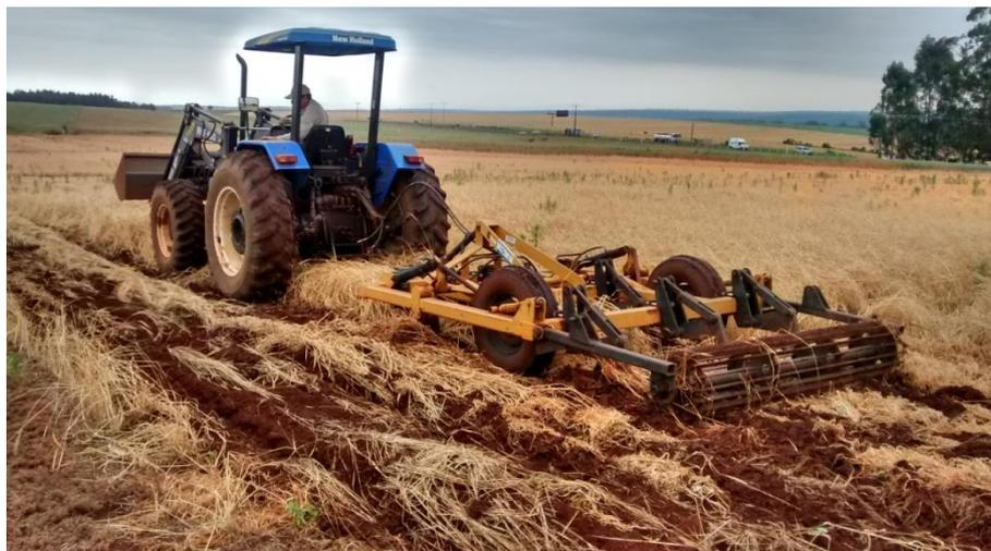
Figura 6. Escarificação da área a 30 cm de profundidade antes do plantio da soja.
