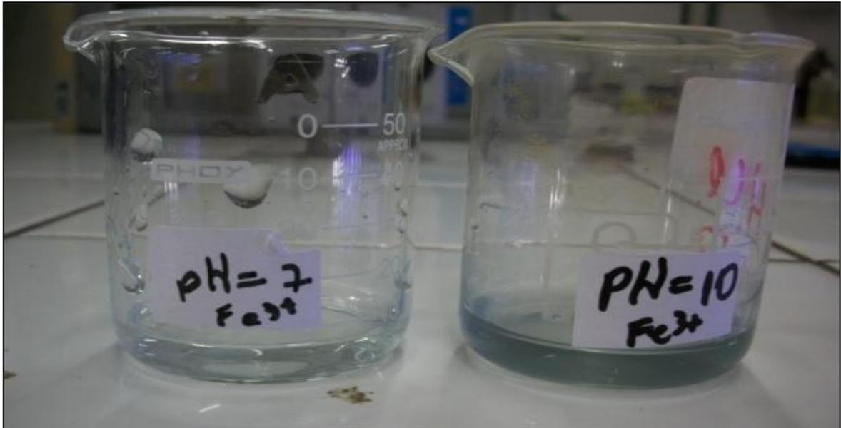
**Figura 12 - Amostra de solução de sulfato de sódio em pH 7 e pH 10 na presença de Ferro III após 12 horas de borbulhamento de oxigênio (ar) e realização do teste AlfaKit®.**
