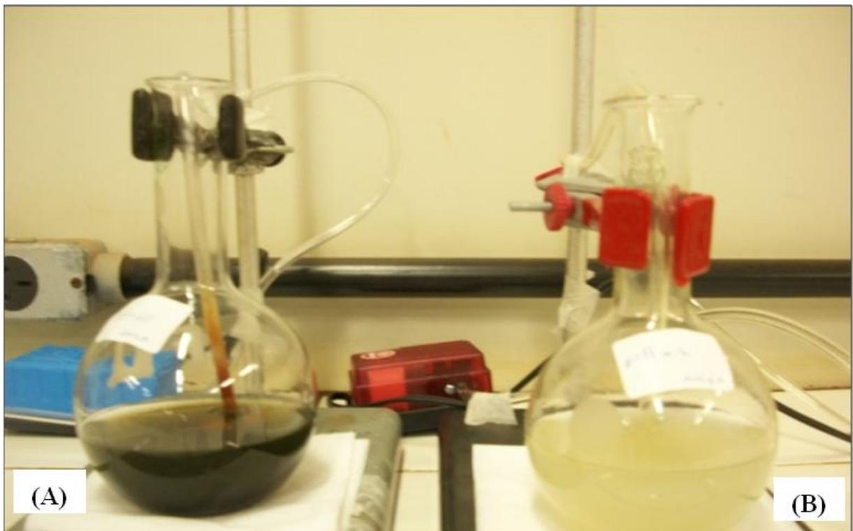
**Figura 11 - Esquema de borbulhamento de oxigênio (ar) nas amostras de solução de sulfeto de sódio na presença de Ferro III em pH 10 (A) e pH 7 (B).**
