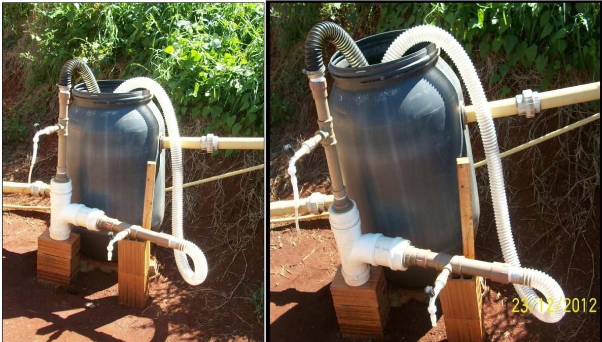
**Figura 14 - Filtro instalado em campo.**
