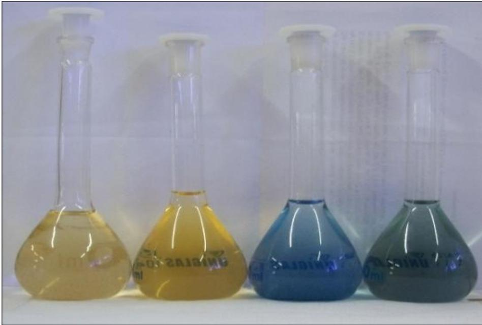
**Figura 30 - Amostras da solução sem uso na purificação (dois primeiros frascos) e após uso na purificação (dois últimos frascos) ambas tratadas com cianeto.**
