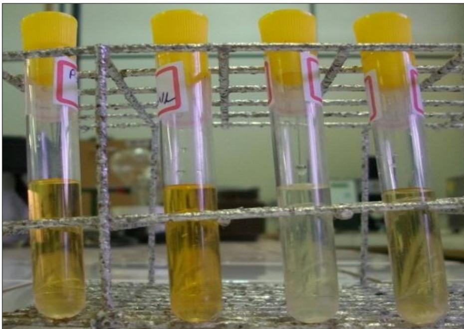
**Figura 29 - Amostras obtidas da solução de Fe(III) antes e após o uso na purificação do biogás.**
