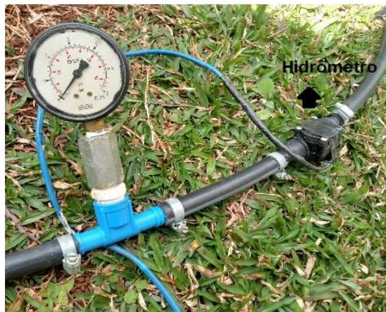
Figura 27. Medidor de vazão de água Yf-s201.
