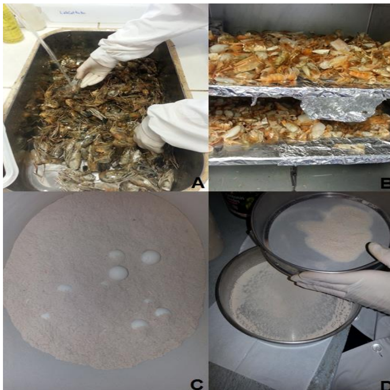
Figura 19. Processamento da carapaça. A- Separação e limpeza da carapaça; B- Secagem em estufa; C- Moagem em moinho de jarros; D- Peneiramento até passagem em malha de 63 \mu m de abertura.
