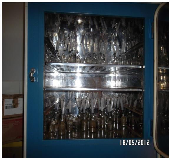
**Figura 13** - Estufa de acondicionamento dos microrreatores.
