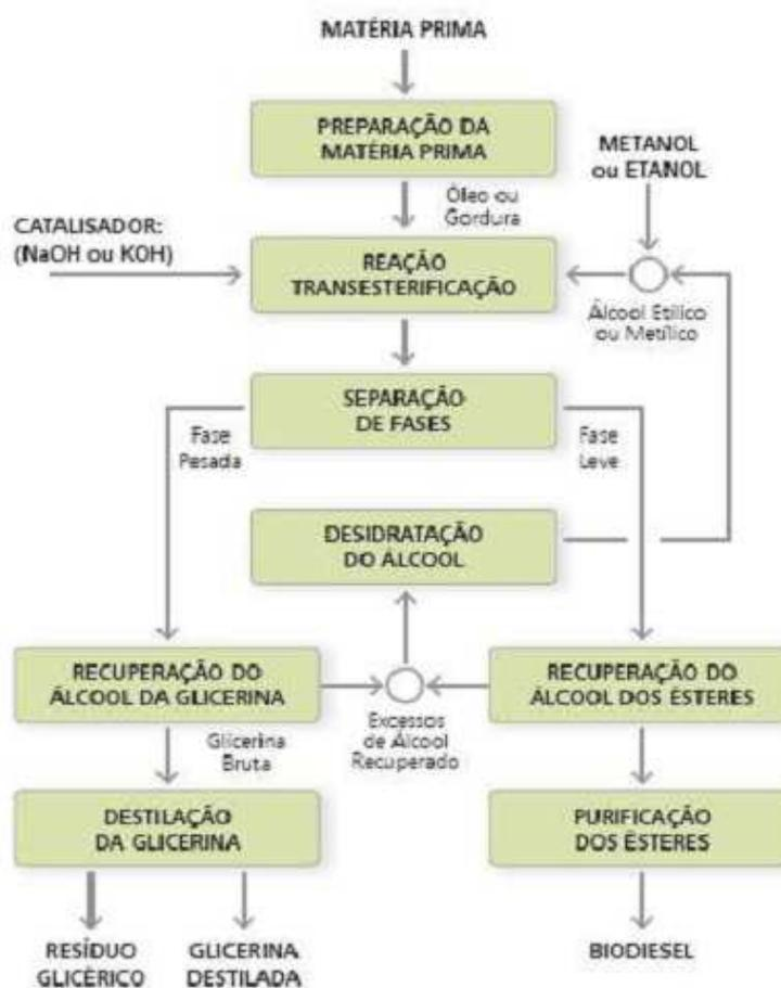
**Figura 9** - Processo de produção do biodiesel.
