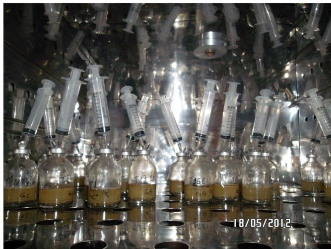
**Figura 12 - Microrreatores utilizados na produção de biogás.**
