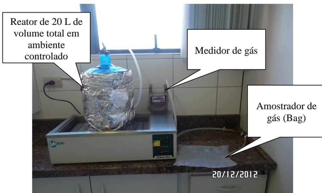
**Figura 18 - Biodigestor em escala laboratorial.**
