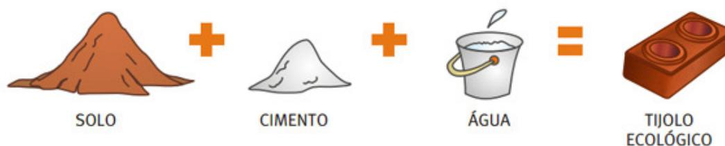
FIGURA 5 - Componentes para fabricação de tijolos
