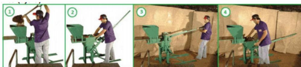
FIGURA 8 - Processo de Prensagem dos tijolos
