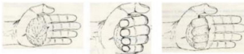
FIGURA 7 - Esquematização de verificação da umidade ideal da mistura
