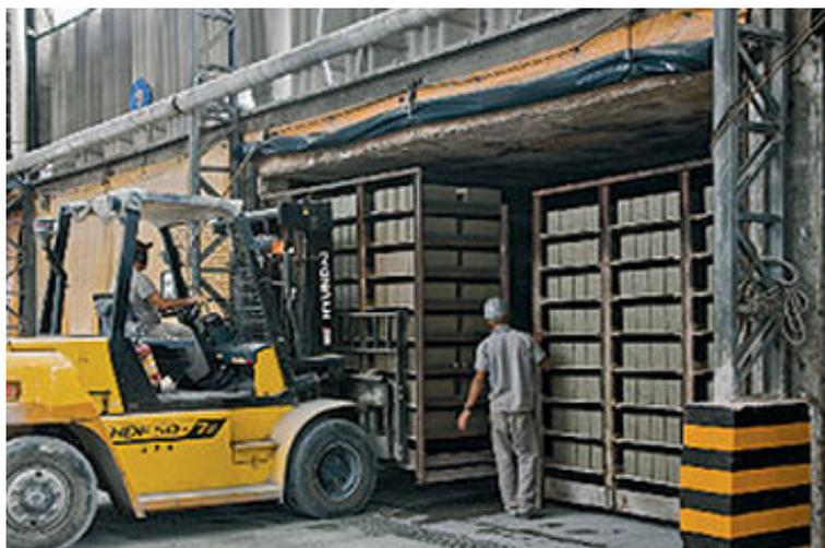
FIGURA 24 - Processo de cura por câmara a vapor.
