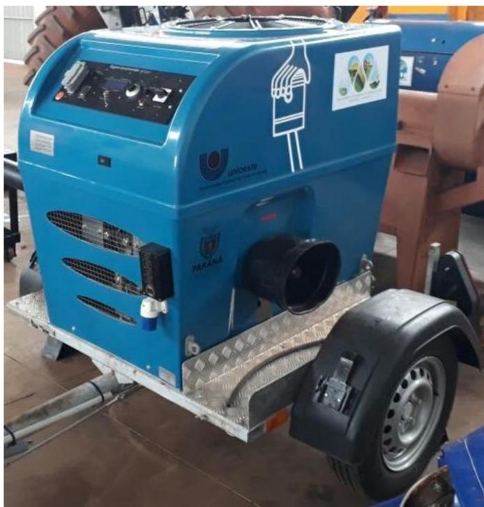
**Figura 12** - Dinamômetro EGGERS, modelo PT170.
