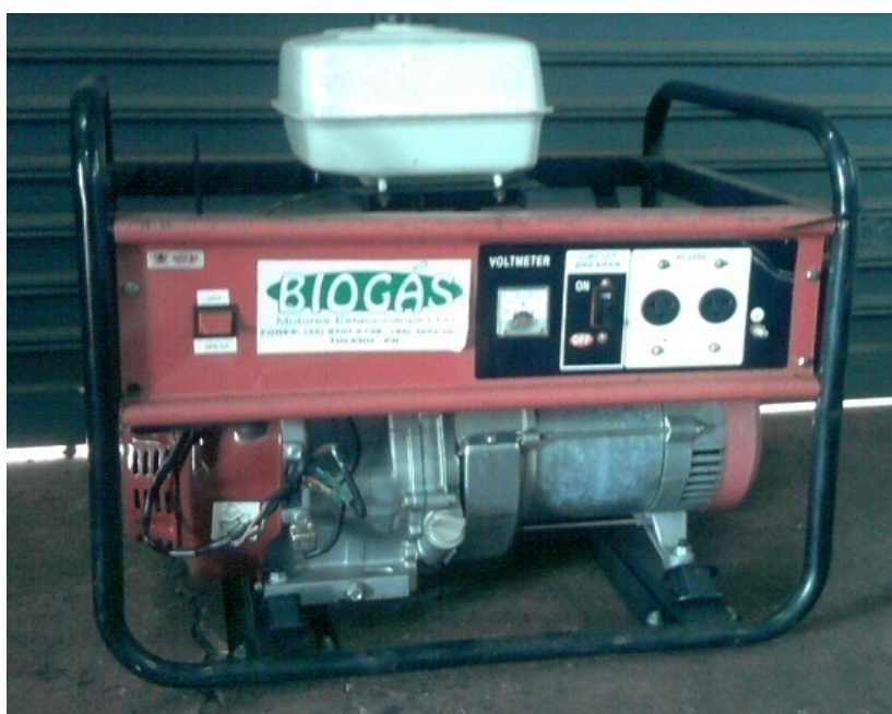
Figura 12 – Motor-gerador utilizado no ensaio.
