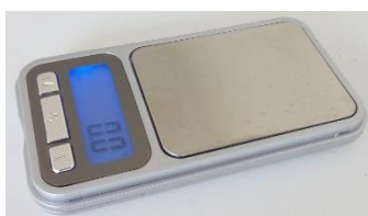
Figura 33. Balança portátil de precisão Quanta modelo - QTBB-1000G.
