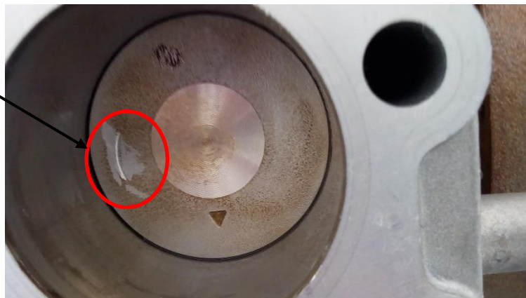
Figura 43. Resultado final condicionamento base do pistão do GMG Toyama - modelo TF1200CXW1.
