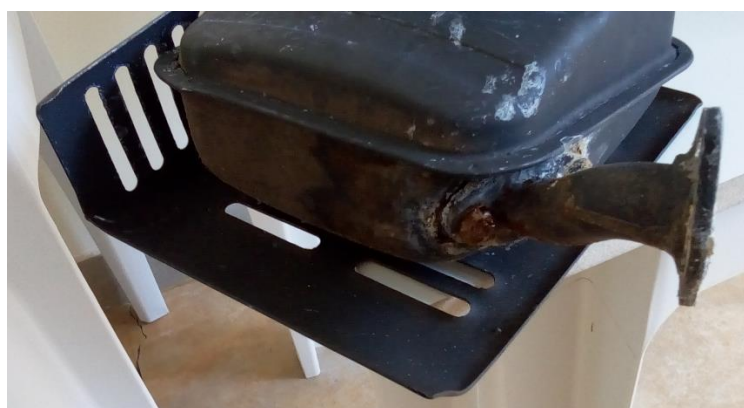
Figura 44. Sistema de exaustão apresentando sinais de oxidação.
