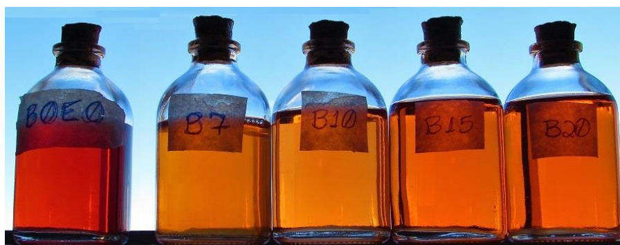
Figura 18 - Combustíveis sem etanol (B0E0, B7E0, B10E0, B15E0 e B20E0). Fonte: Elaborado pelo autor.
