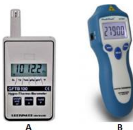
Figura 12 - Equipamentos complementares: (A) Termo-higro-barômetro; (B) Tacômetro digital. Fonte: Elaborado pelo autor.
