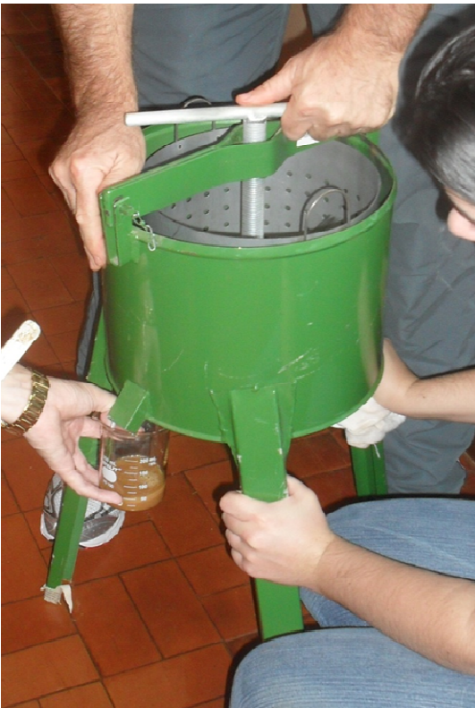
Figura 06 Prensagem do Resíduo cozido
