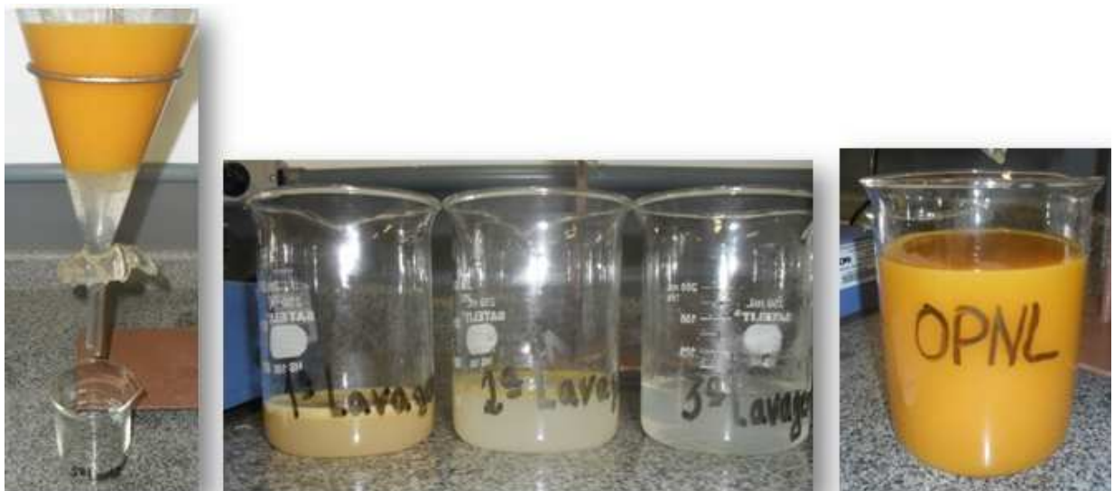
Figura 07 Lavagem do óleo de tilápia neutralizado.
