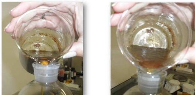
Figura 05 Neutralização do óleo de peixe - separação em funil de vidro.
