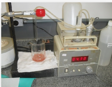
Figura 04 Determinação da acidez
