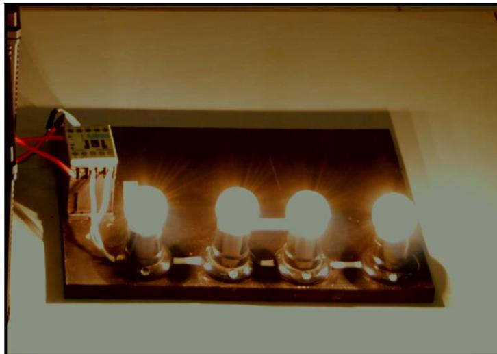
**Figura 31** – Carga instalada, composta por quatro lâmpadas incandescentes de 60 W cada.
