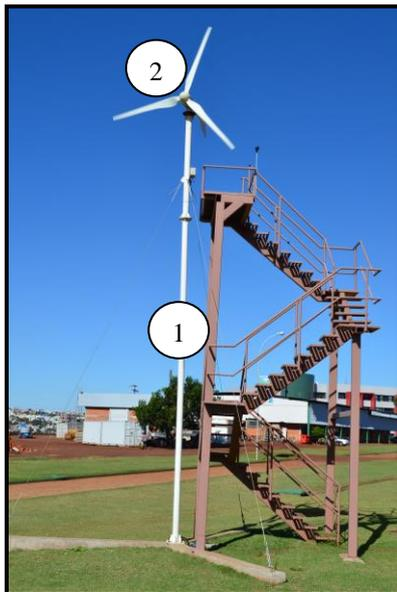
**Figura 21** – 1 – Torre utilizada para instalação do aerogerador; 2 – Aerogerador.
