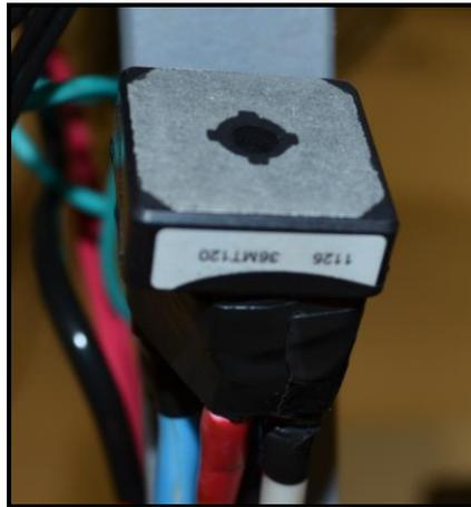
**Figura 25** – Ponte retificadora trifásica, modelo 36MT120.
