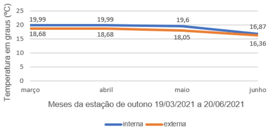
**Figura 44.** Comportamento da temperatura interna (°C) em relação a externa, do módulo de bloco cerâmico sem cobertura verde, na estação de outono.
