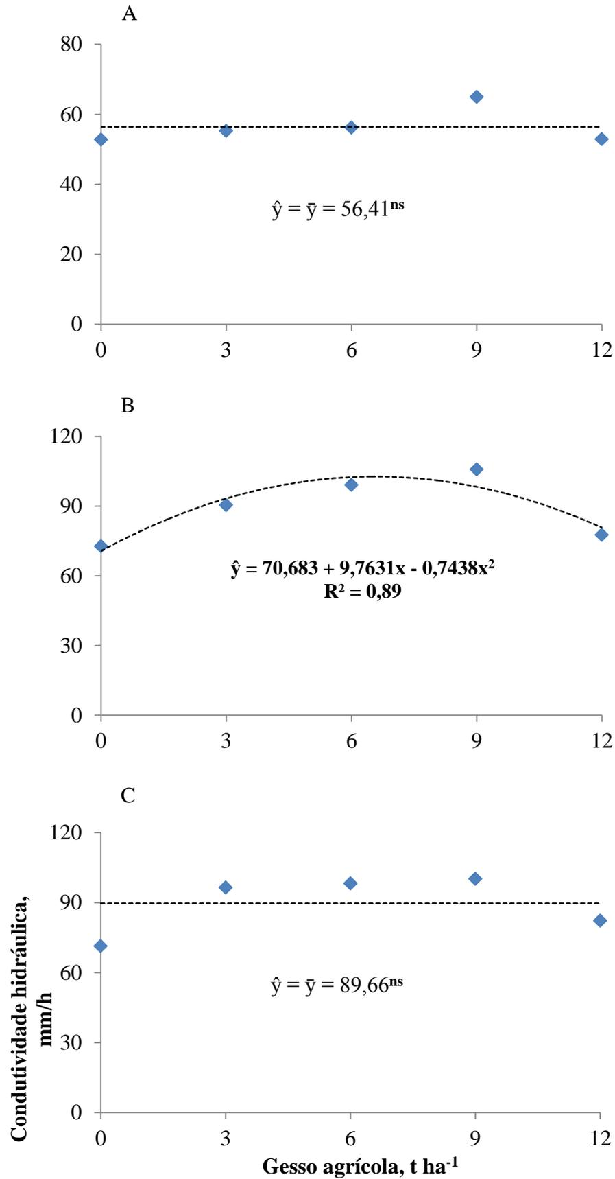
Figura 8. Condutividade hidráulica do solo nas camadas de 0,0 - 0,1 (A), 0,1 - 0,2 (B) e 0,2 - 0,3 m (C) em função das doses de gesso agrícola.
