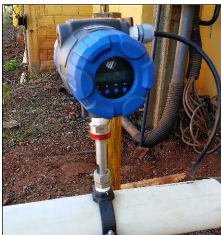
**Figura 10.** Medidor de vazão da marca Magnetrol
