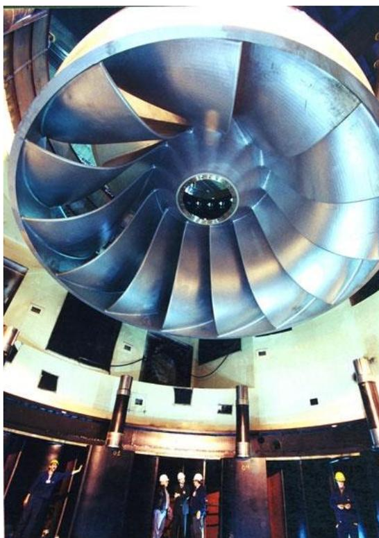
Figura 11 - Rotor Turbina da Usina de Itaipú
