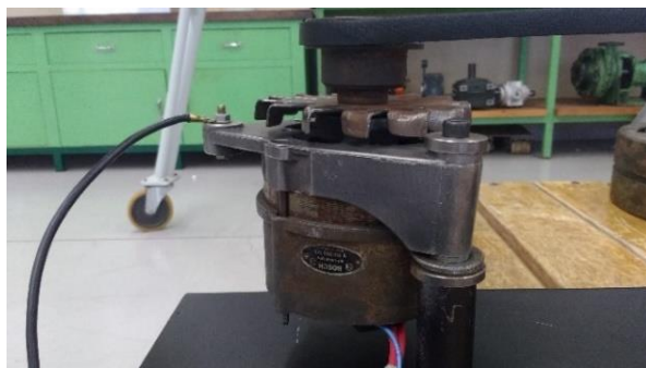
Figura 19: Modelo gerador CA tipo alternador automotivo Fonte: do autor
