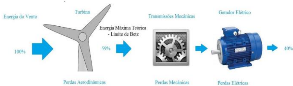
Figura 7: Representação da estimativa de perdas em um aerogerador eólico Fonte: Tedesco Henrique - 2015
