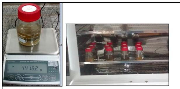
FIGURA 17: PESAGEM E INSERÇÃO DOS BIODIGESTORES NA ESTUFA.
