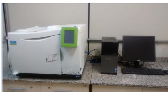
FIGURA 19: CROMATÓGRAFO UTILIZADO PARA LEITURA DOS COMPONENTES DO BIOGÁS.
