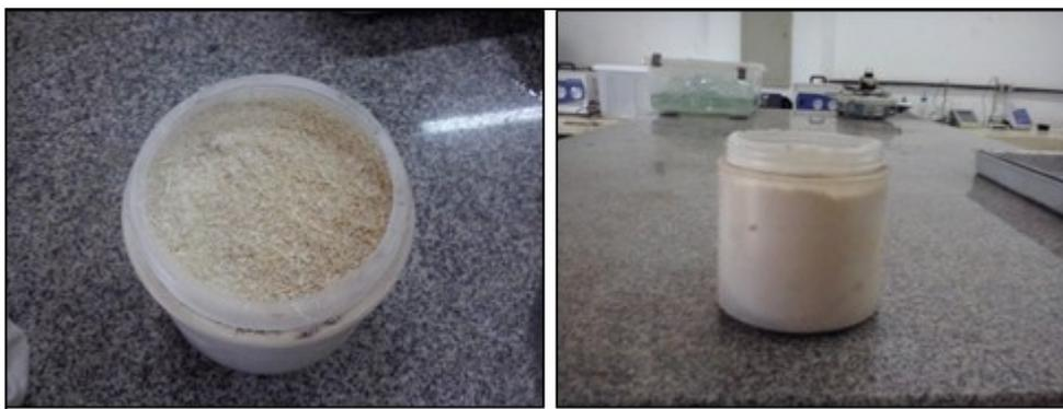
FIGURA 15: BAGAÇO DE CANA APÓS TRATAMENTO MECÂNICO NO MOINHO.
