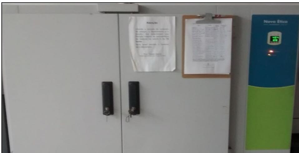
FIGURA 13: ESTUFA DE VENTILAÇÃO FORÇADA.
