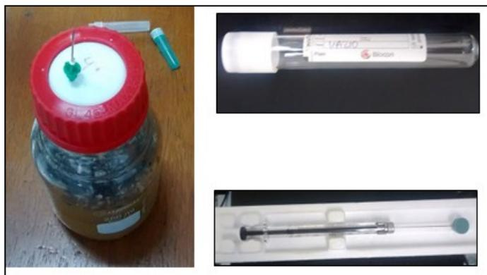
FIGURA 20: PROCESSO DE REMOÇÃO DO BIOGÁS COM SERINGA.
