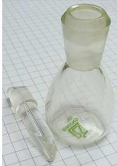
Figura 11. Picnômetro para determinação da densidade
