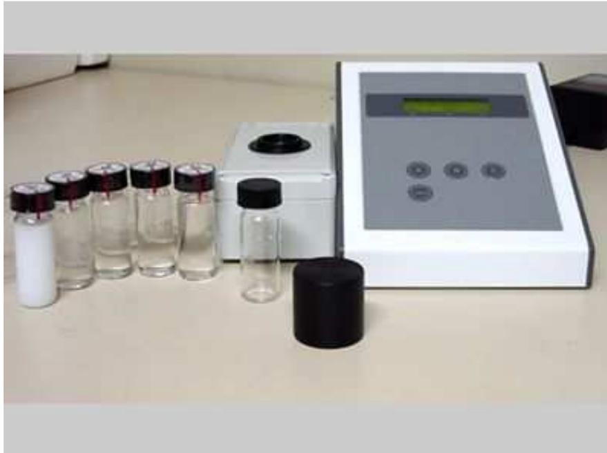
Figura 13. Turbidímetro TB-1000 - Tecnopon
