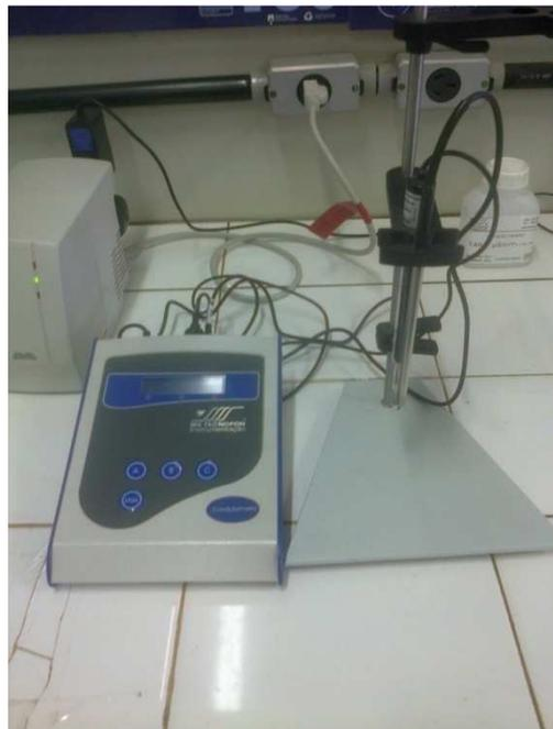
Figura 12. Condutímetro MS Tecponon
