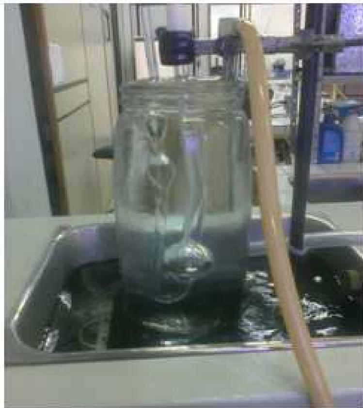
Figura 9. Fotografia do viscosímetro em banho a 20 °C
