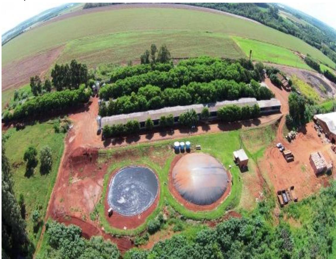
**Figura 10:** Foto aérea do biodigestor mistura completa.
