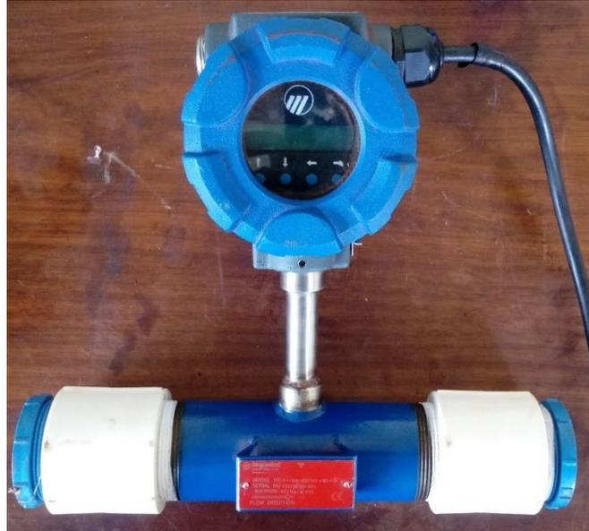
Figura 23 Medidor Termal de Fluxo de Biogás
