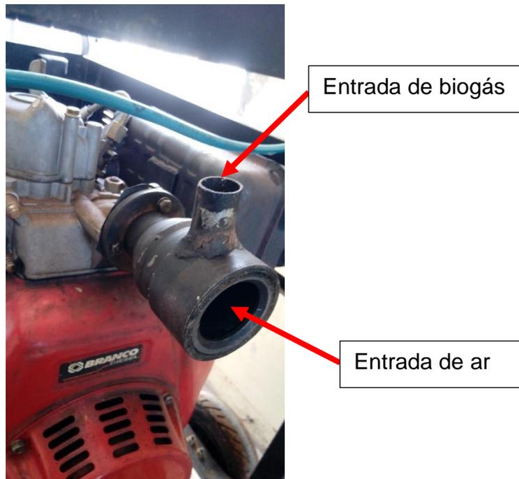
Figura 11 Misturador de gases tipo Venturi
