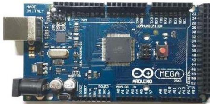
Figura 14 Microcontrolador ATmega2560
