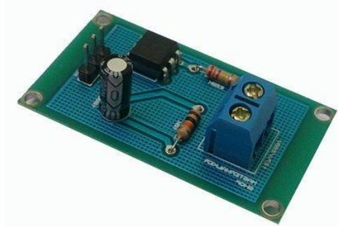
Figura 20 Sensor de Tensão
