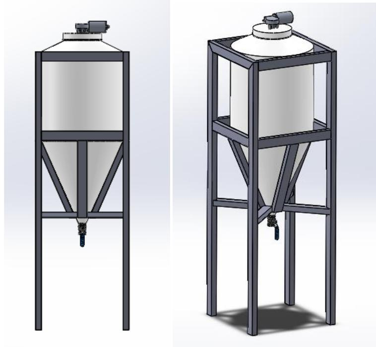
Figura 3 Projeto do Reator de Biodiesel
