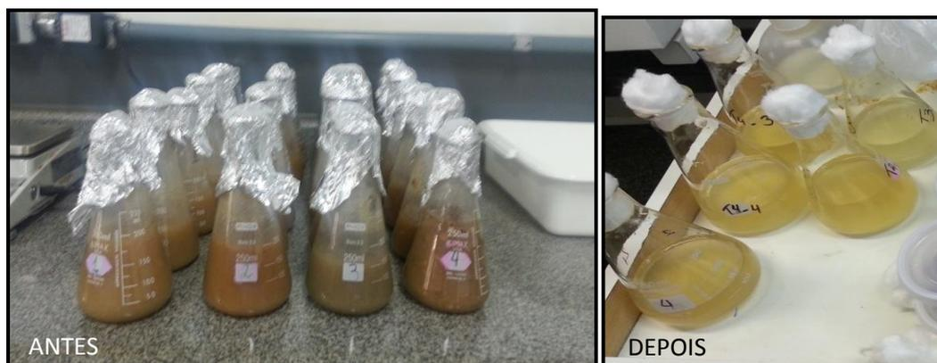
**Figura 7:** Hidrolisado antes e após o processo de filtragem.
