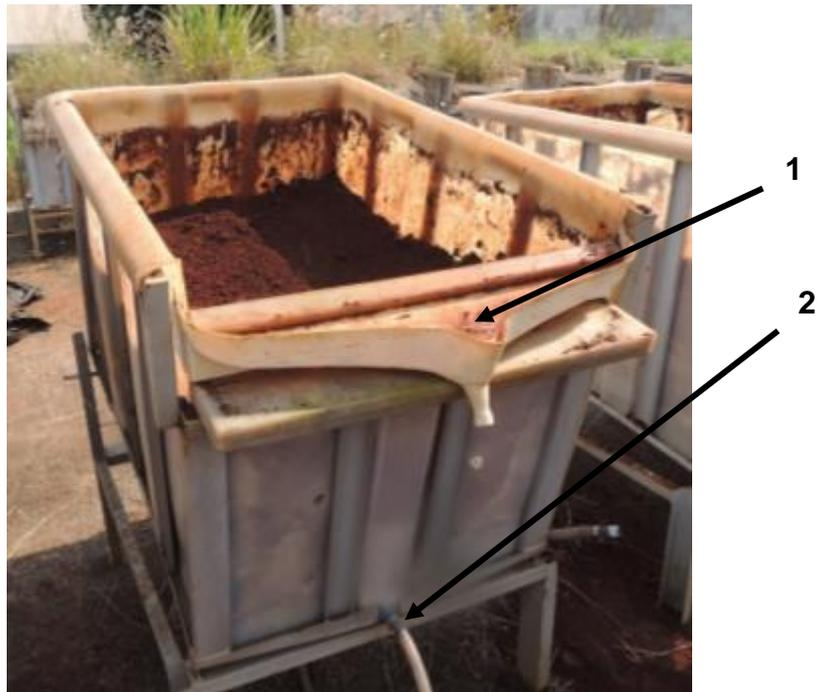
Figura 11. Caixa coletora sem tratamento na superfície.
