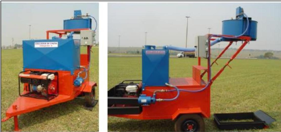
Figura 10. Simulador e chuva InfiAsper/UFMS móvel.
