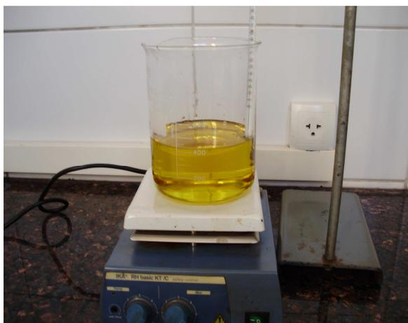
Figura 7 – Agitador magnético usado nas aditivações.
