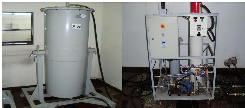
Figura 5 – Unidade Percoladora utilizada para melhorar fator potência.
