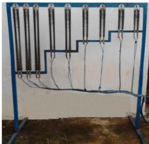
Figura 7 - Banco de resistências
