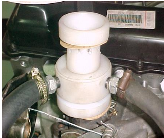
Figura 6 - Misturador tipo Venturi Fonte: Souza 2004.
