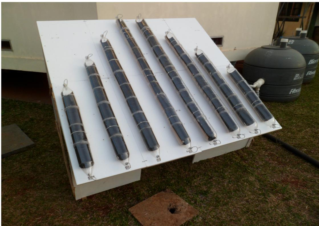
**Figura 1 – Vista frontal da composição dos tubos coletores e painel com inclinação e orientação determinados.**
