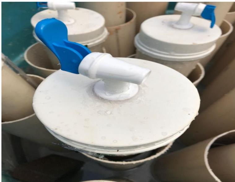
Figura 7 - Válvula para liberação do gás produzido
