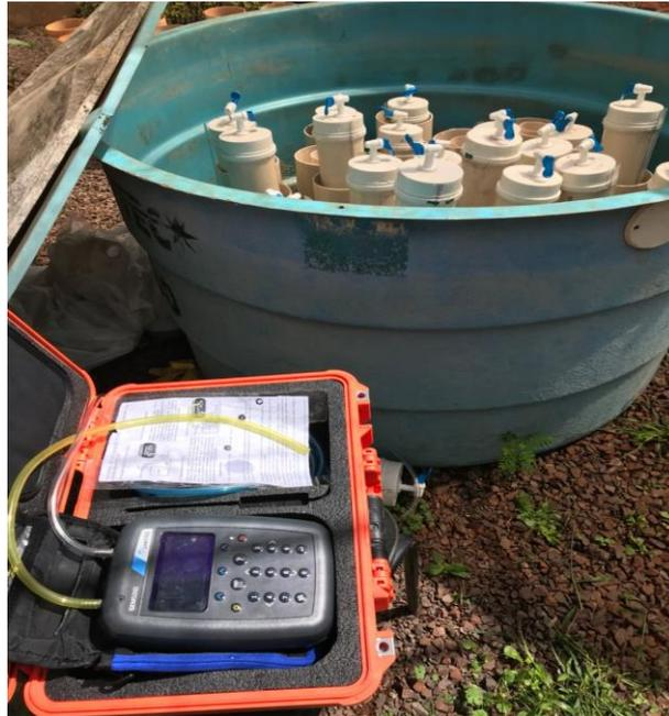
Figura 20 - Análise da concentração de gases.
