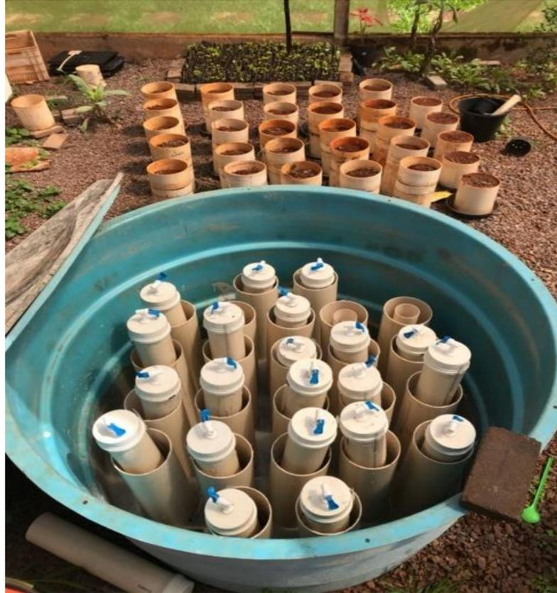
Figura 5 - Caixa d'água com os 24 biodigestores
