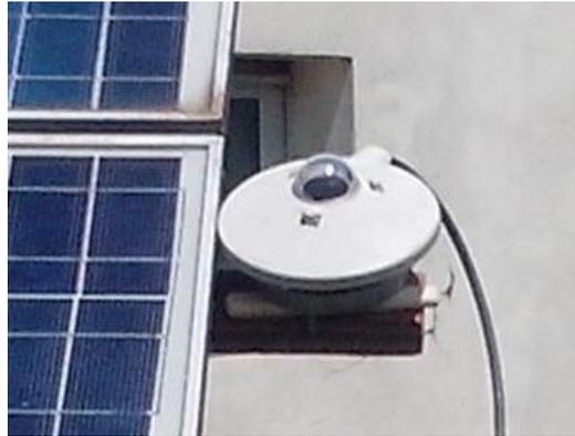
Figura 24. Piranômetro CMP3 instalado no plano dos painéis.
