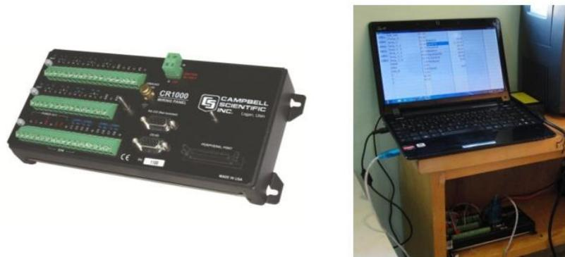
Figura 18. Datalogger CR-1000 e computador utilizado no experimento.
