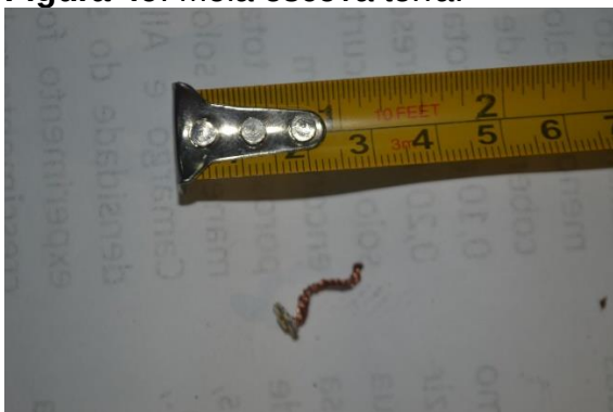
Figura 50: Ligação escova terra com parte metálica da nacele.
