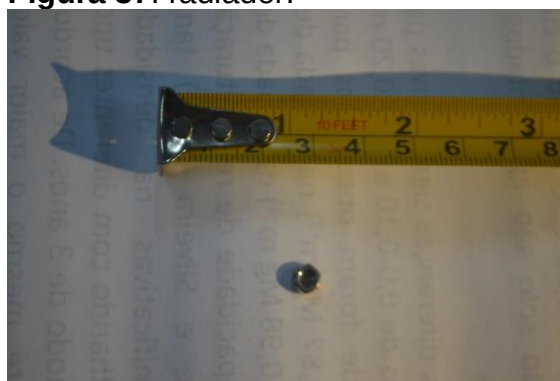
Figura 38: Porcas M6, união mancal das pás com pás.
