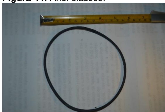
Figura 45: Borracha isolamento contra intempéries posicionada entre o mancal do estator e nacele.
