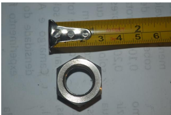
Figura 55: Porca fixação mancal pás a eixo horizontal.
