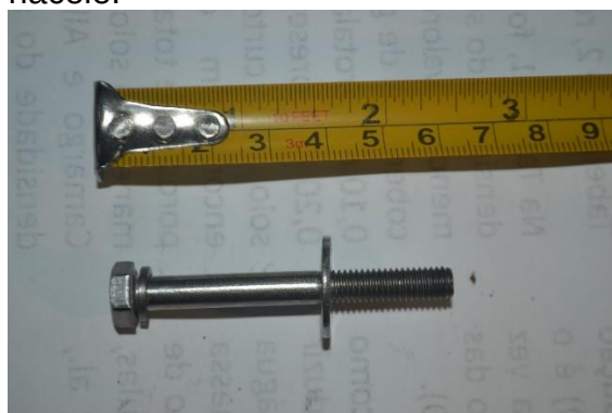
Figura 53: Parafuso fixação do eixo escova.
