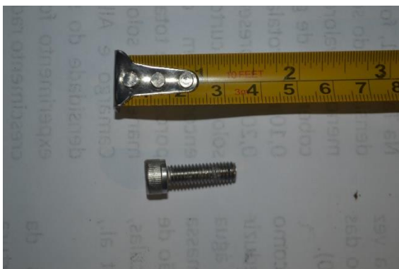
Figura 47: Parafusos M6 x 20, união das pás com mancal das pás.
