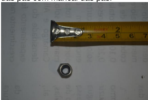
Figura 48: Porcas M6, união mancal das pás com pás.
