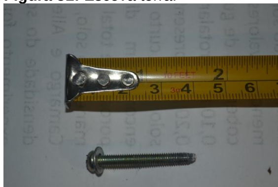
Figura 52: Parafusos união placa a nacele.
